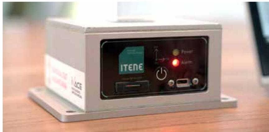
Dispositivo de medición data recorder de ITENE de los riesgos de la distribución.
