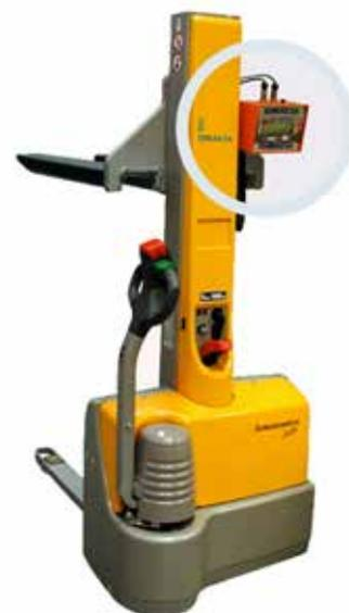
maquinarias y de una funda exterior. El cableado se realiza por dentro de la máquina y para la alimentación se aprovechan las baterías de la propia máquina.
